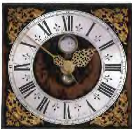
Afbeelding 2 – Wijzerplaat: verzilverde cijferring op met fluweel overtrokken ijzeren plaat
