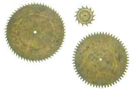
Afbeelding 8 – De passerlijnen zijn op deze tandwielen zichtbaar
