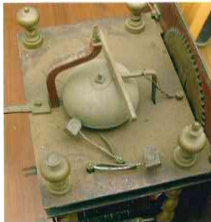
Afbeelding 7 – Hamers van slagwerk en wekker
