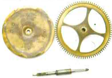
Afbeelding 5 – Wijzerklemming met uitneembare as
