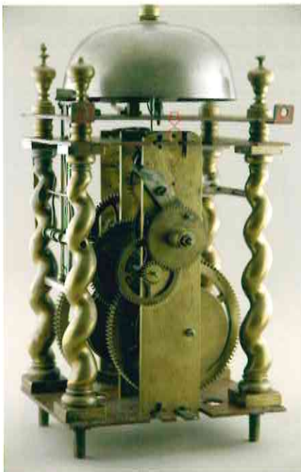
Afbeelding 6 – Lagering van het anker in de voorste stijl
